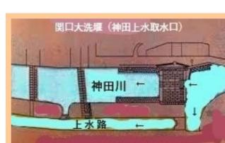
(上) 関口大洗堰。目白関口に堰を設け、神田川の水位を上げて取水し石樋や木樋で地下を通し神田上水として江戸に飲料水を供給した。
